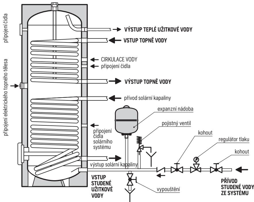
pro regulaci teploty vody a nastavte jej na teplotu přibližně 60 °C, aby se snížila tvorba vodního kamene. Naplňte vodní a topný okruh, přičemž dbejte na odvzdušnění systému. Pokud je voda velmi tvrdá, doporučujeme instalovat před ohřívač změkčovač vody, aby se zabránilo usazování vodního kamene.
